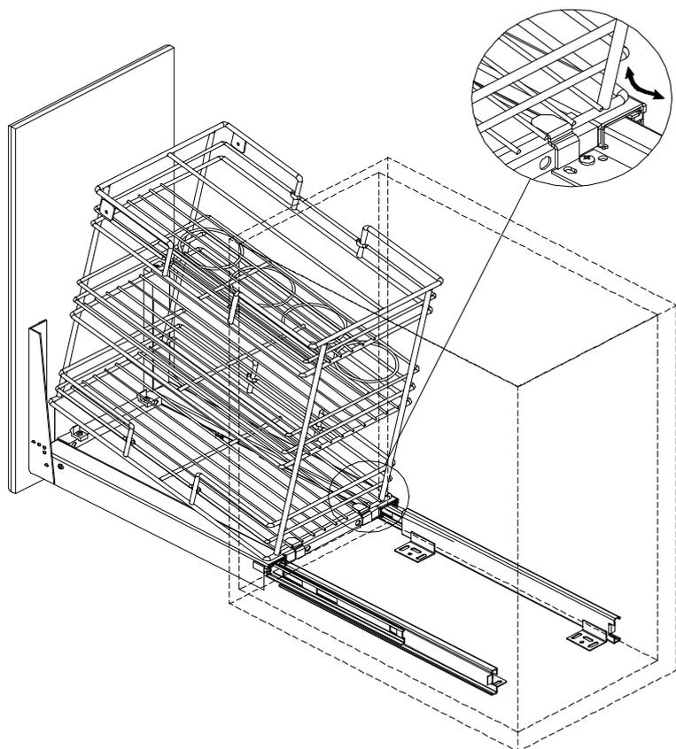
4. Зафиксируйте корзину при помощи угловых кронштейнов к фасаду как на картинке. Убедитесь, что карго движется плавно и ровно.
