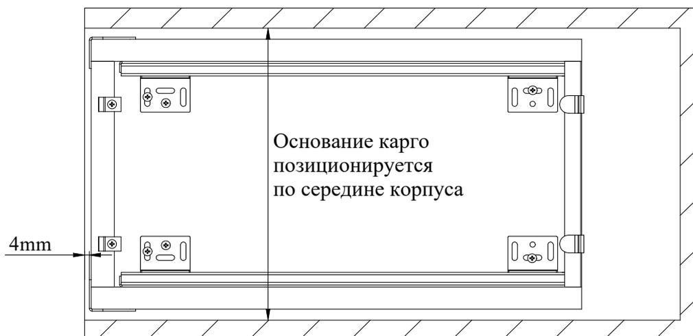
2. присоединение фасадную панель при помощи шурупов в овальные отверстия к основанию и отрегулировав положение относительно корпуса, зафиксируйте.
